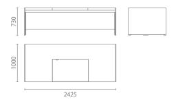
Model 型号: SIZE-BT-01 Size 尺寸: W2425 D1000 H730
