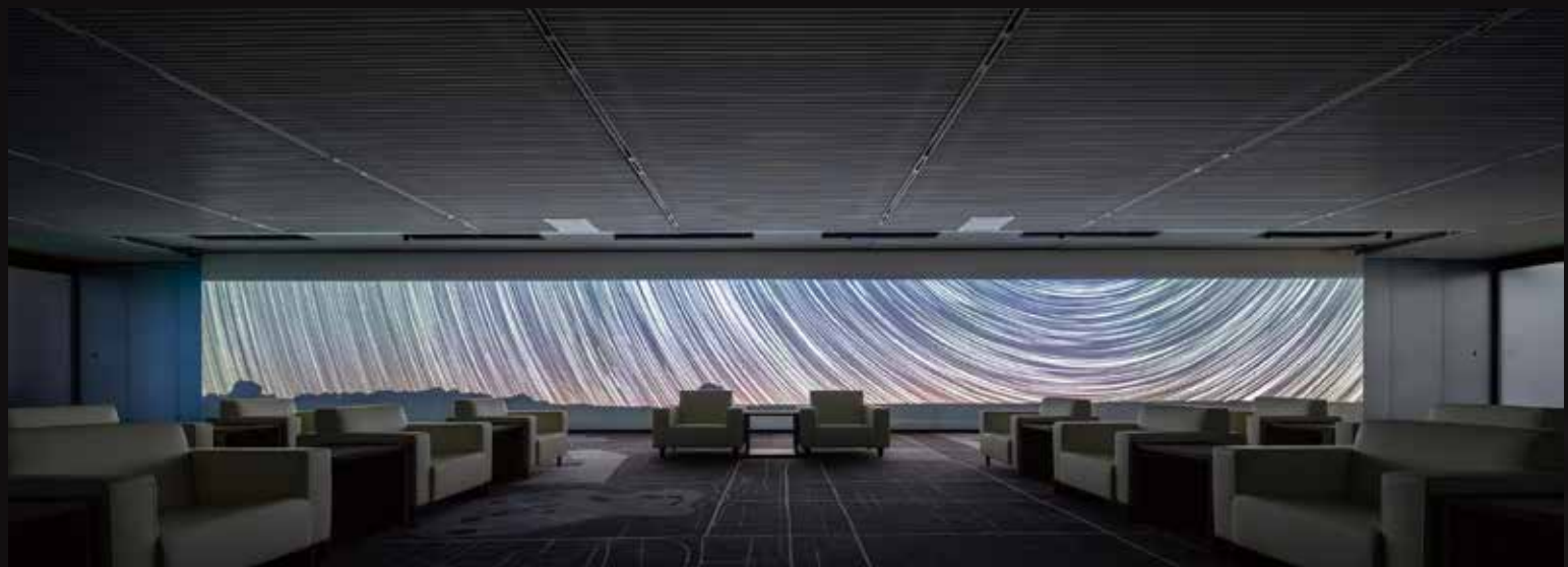
↓（主会客厅）隐藏在天花里的激光超短焦投影机将星空画面投射于无边框的布面墙面上。
